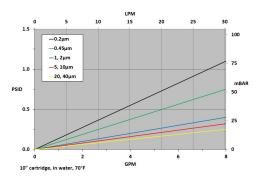
\*すべてのデータは絶対ろ過精度のメディアに基づいています。公称ろ過精度のメディアは、圧力損失が約10%減少します。
